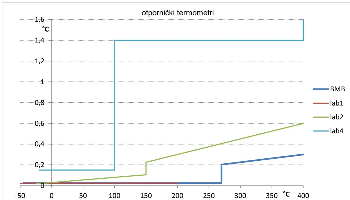
Za umjeravanje otporničkih termometara ukupno je akreditirano svega 4 laboratorija.
